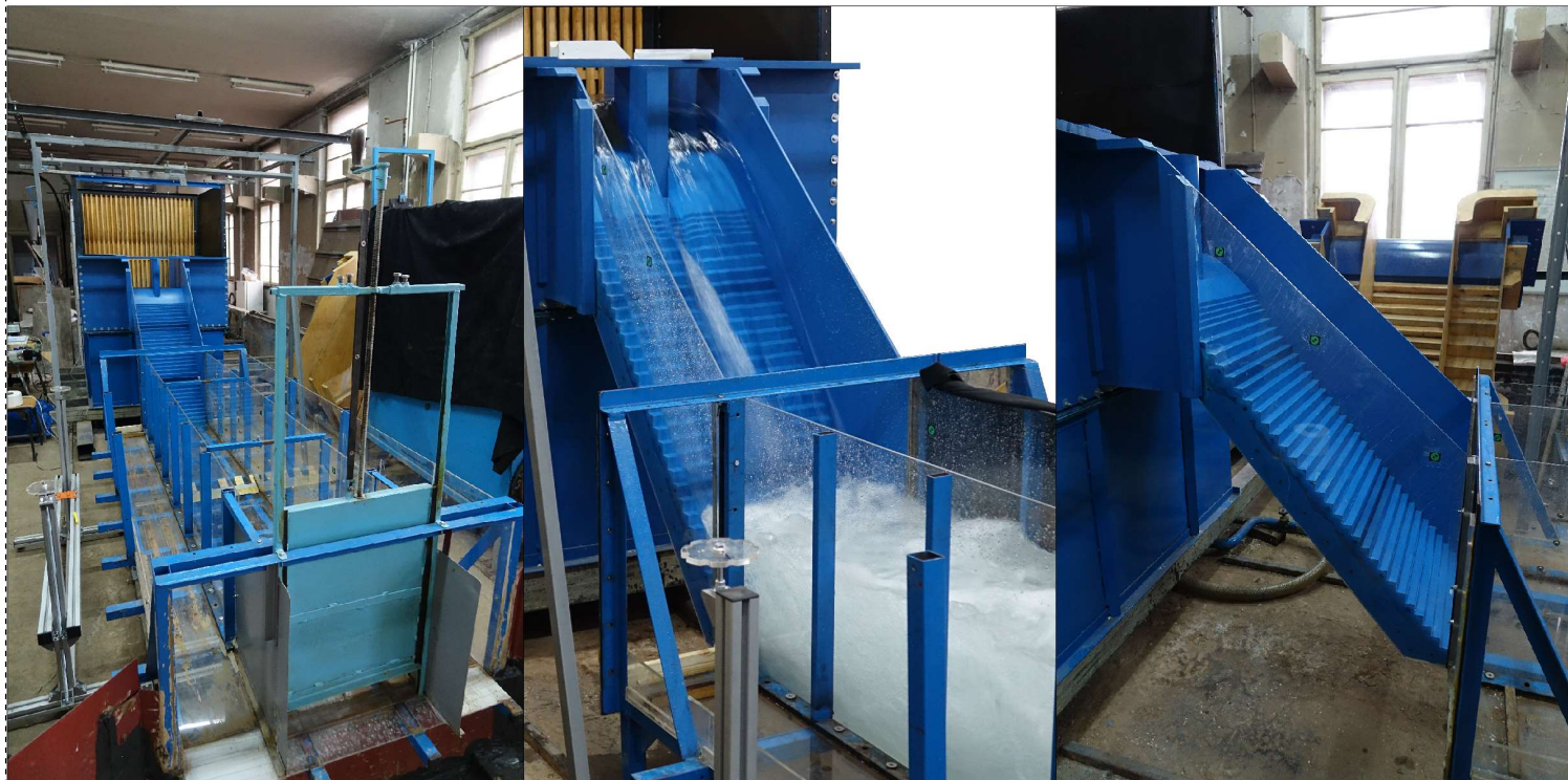
Физички модел степенастог брзотока израђен у Лабораторији за хидраулику и уређење водних токова Института за хидротехнику и водно еколошко инжењерство
